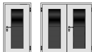
Szellőzőlamellák (szellőzőkeresztmetszet kb. 20 %) Peremszélesség minden oldalon min. 180 mm
